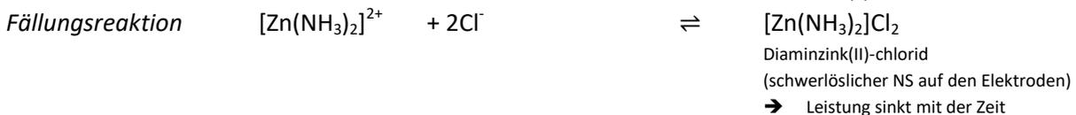
AA Formulieren Sie die Teilreaktionsgleichungen und die Gesamtgleichung der Primärreaktionen sowie die Gleichungen der Sekundärreaktionen für die **Vorgänge an den Elektroden einer Zink-Kohle-Batterie/ Alkaline**. Edukte und Produkte entsprechen im Wesentlichen jenen im Leclanché-Element, allerdings läuft das Ganze im Alkalischen ab und statt  $\text{Mn}_2\text{O}_3$  entsteht  $\text{MnO}(\text{OH})$  (Lösung: vgl. Buch Seite 112).
